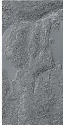
Das Oberflächenmodell macht die Struktur der Oberfläche des Waldes sowie der Gebäude sichtbar. Die Felsmassive sind in diesem Modell nahezu unsichtbar.
