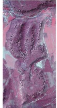
Die Kombination aus dem digitalen Luftbild und dem Bodenmodell ermöglicht eine dreidimensionale Abbildung der Nikolsdorfer Wände, in der die Topografie und die Oberflächenbedeckung deutlich erkennbar sind.
